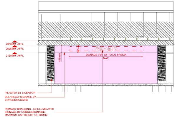
2 ELEVATION A Scale: 1:50
